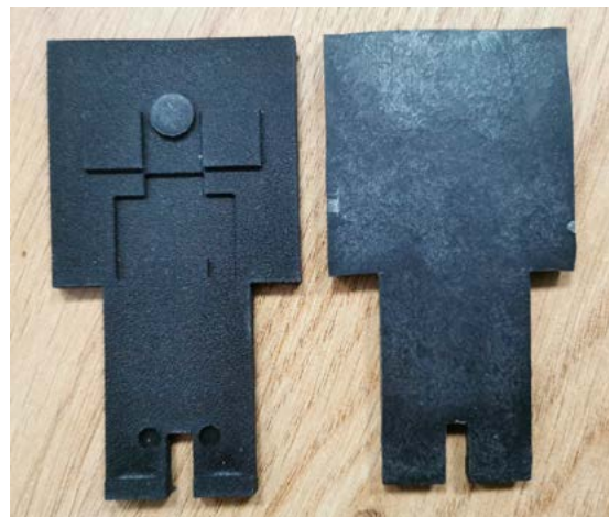
Razlika v izgledu površine, kjer je kos v stiku s 3D natisnjeno površino (levi kos) in kovinsko površino (desni kos)
