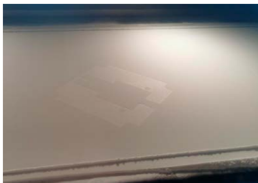
SLS tiskanje orodnega vložka
