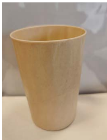
Lončki iz nanokonpozitnega materiala PLA in PBAT z dodatkom nanokristalinične celuloze
