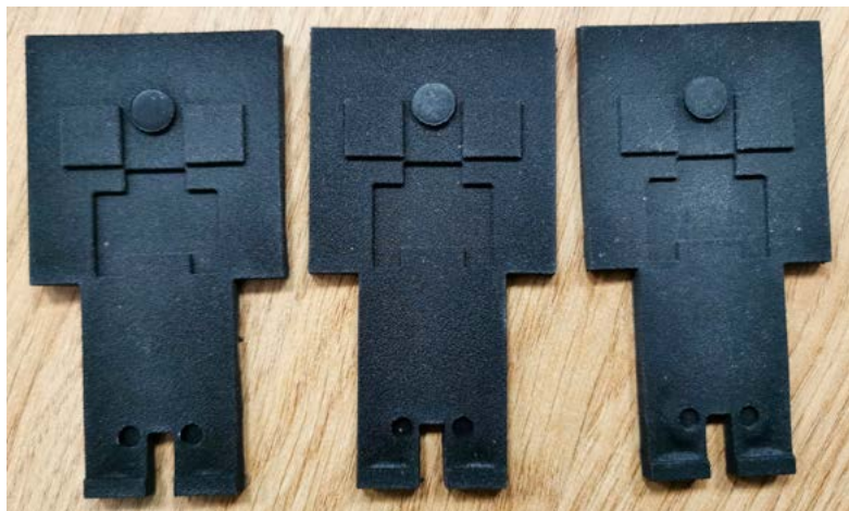
Nabrizgani kosi iz biokompozita rPP z dodatkom 15 % odpadnega papirja iz 3D natisnjen orodni vložek z SLS tehnologijo
