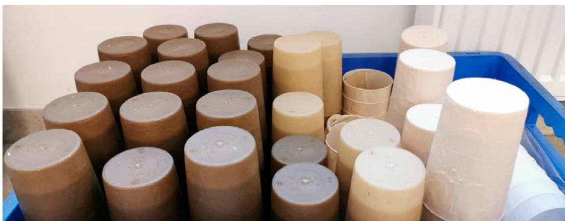
Nabrizgani demonstratorji FTPO v podjetju OPS Breznik
