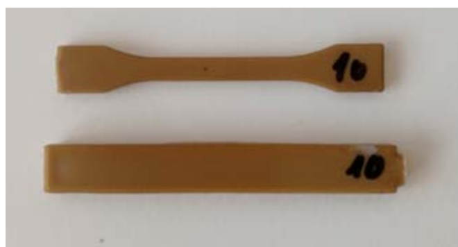
Preizkušanci za testiranje mehanskih lastnosti pripravljeni iz sintetiziranega PET
