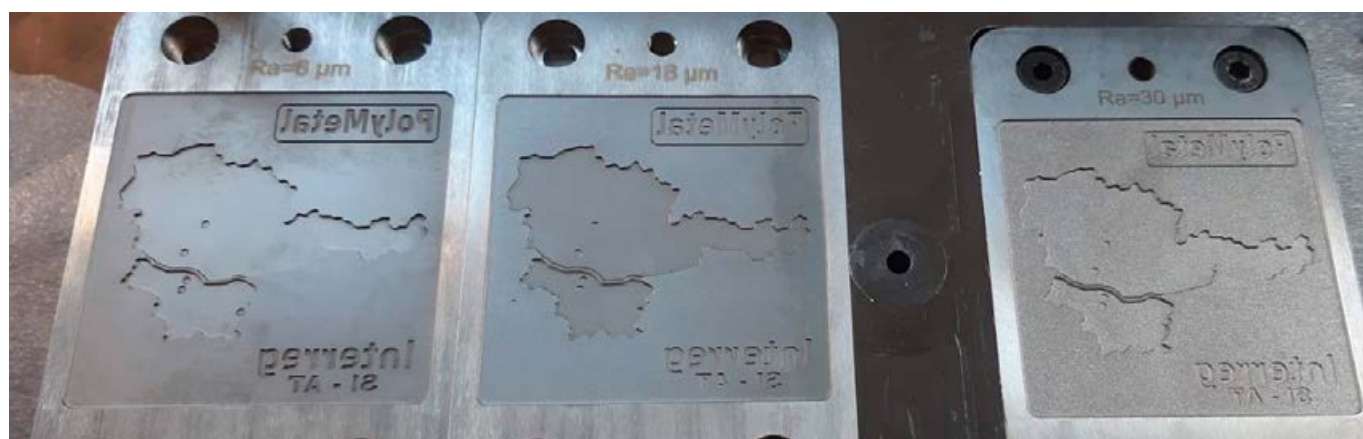
Gravurni vložki za PolyMetal demonstratorje z različno hrapavostjo površin
