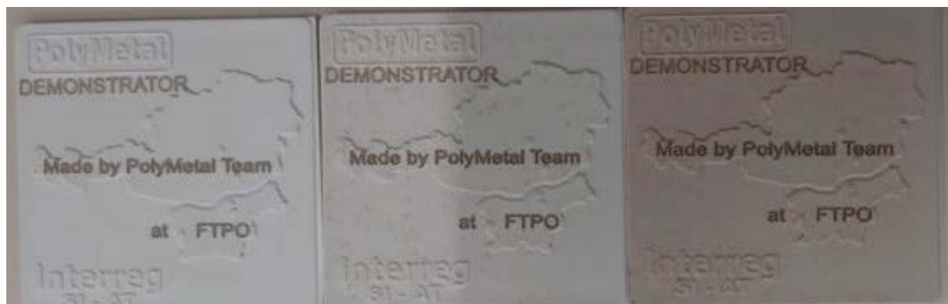
PolyMetal demonstratorji izdelani iz kompozitov s PP matrico in dodanim BN
