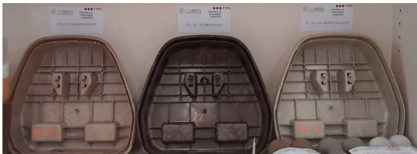
Slika 18: Izdelani prototipi (levo: ABS+ 30 % odpadnega papirja; sredina: Green PE-HD+30 % miskantusa + 15 % talka; desno: Green PE-HD+30 % odpadnega papirja + 15 % talka)
