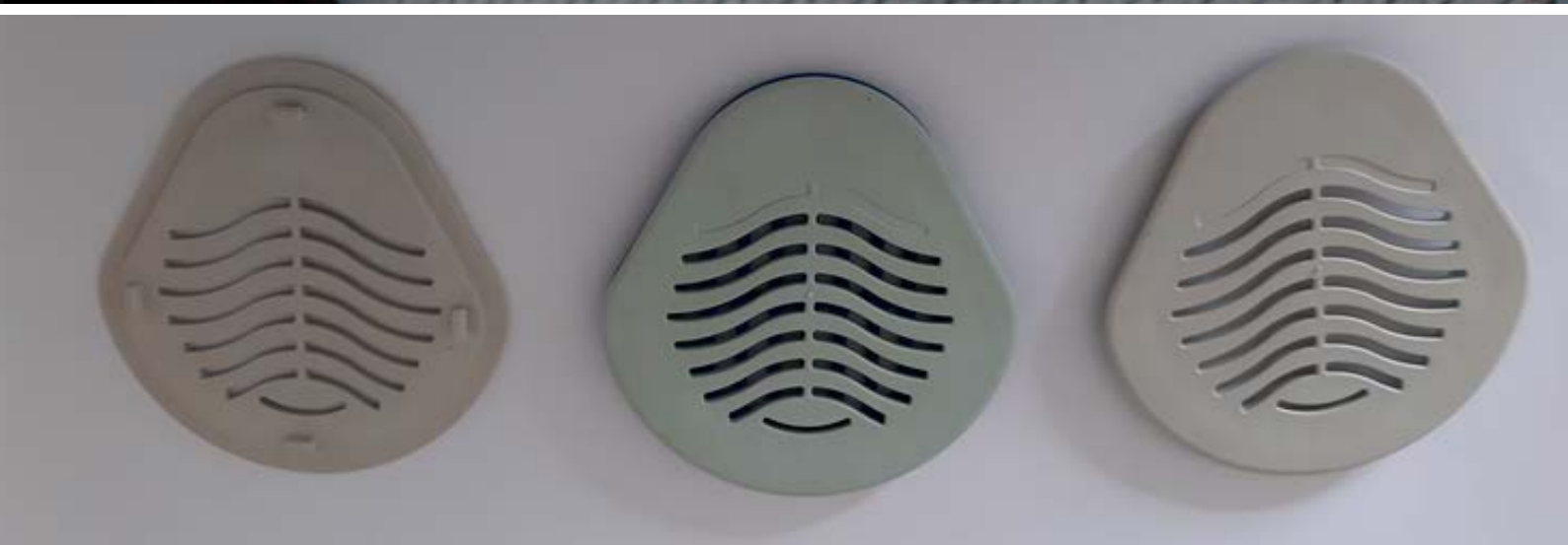
Spodnji in zgornji del filtra za zaščitno masko razvit v podjetjih OPS Breznik in Gumarstvo Šrajner izdelan iz bioosnovanega polietilena visoke gostote z dodatkom 30 % odpadnega papirja – material smo kompavndirali na FTPO
