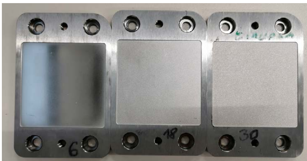
Nabrizgani prototipni reliefni izdelki z različnimi debelinami aluminijaste folije
