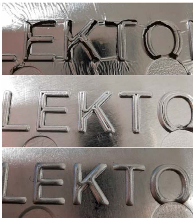
Nabrizgani prototipni reliefni izdelki z različnimi debelinami aluminijaste folije
