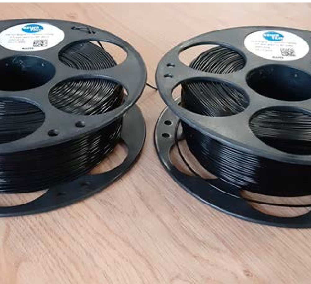
Koluta z navitim filamentom po testu pri 60 °C po 24 urah
