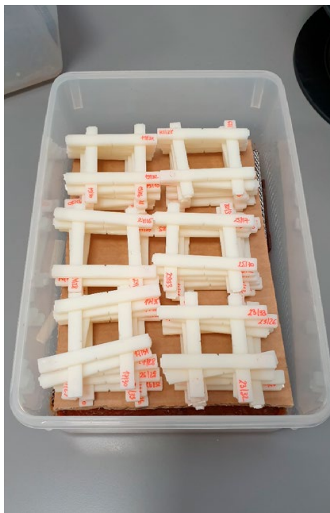
Priprava vzorcev za kondicioniranje v komori
