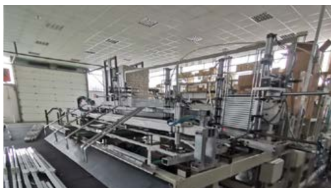
Avtomatska linija za sestavo nosilnih elementov senčnikov v podjetju Suman
