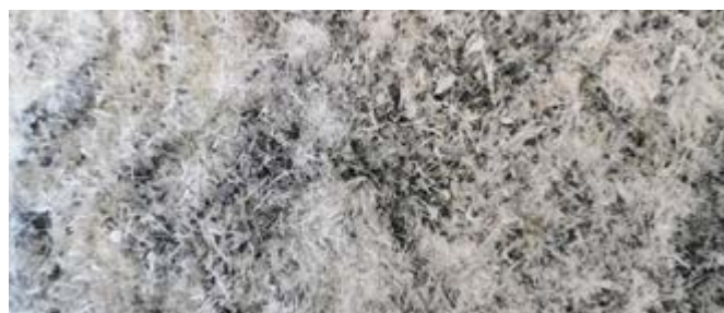
Odpad duroplastičnega kompozita iz podjetja Veplas (levo kot dobavljen, desno zmet)
