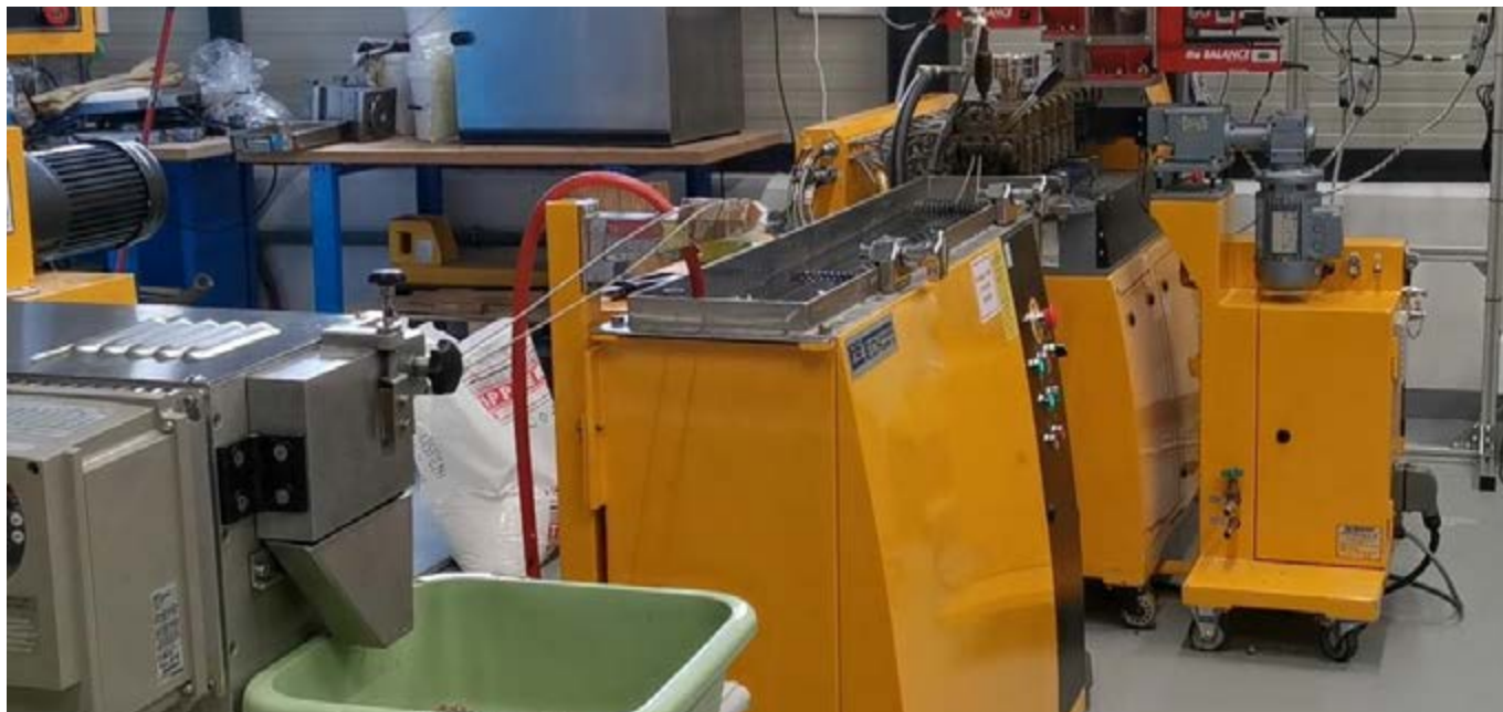
Slika dvopolžnega ekstruderja z gravimetričnim dozirnim sistemom pri izdelavi biokompozita na osnovi recikliranega polipropilena in dodatkom odpadnega papirja
