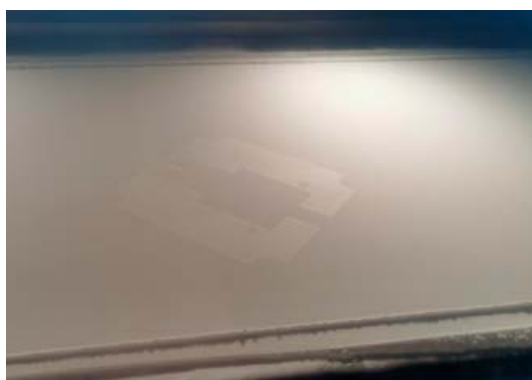
SLS tiskanje orodnega vložka
