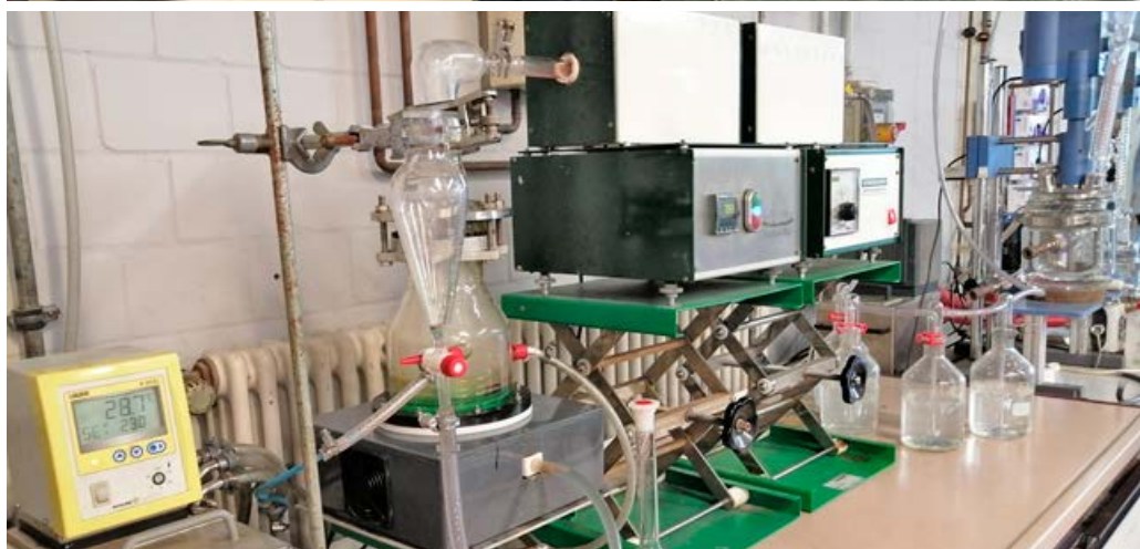
Sistem ultrazvočne razpršilne pirolize za sintezo nanodelcev
