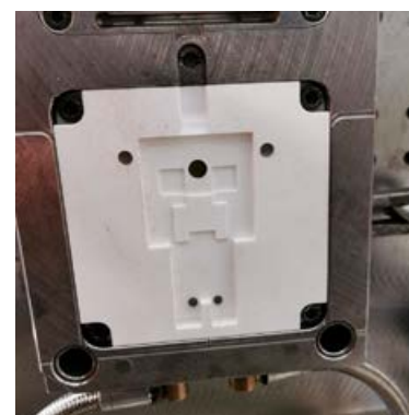
3D natisnjen orodni vložek z SLS tehnologijo montiran v orodje za brizganje
