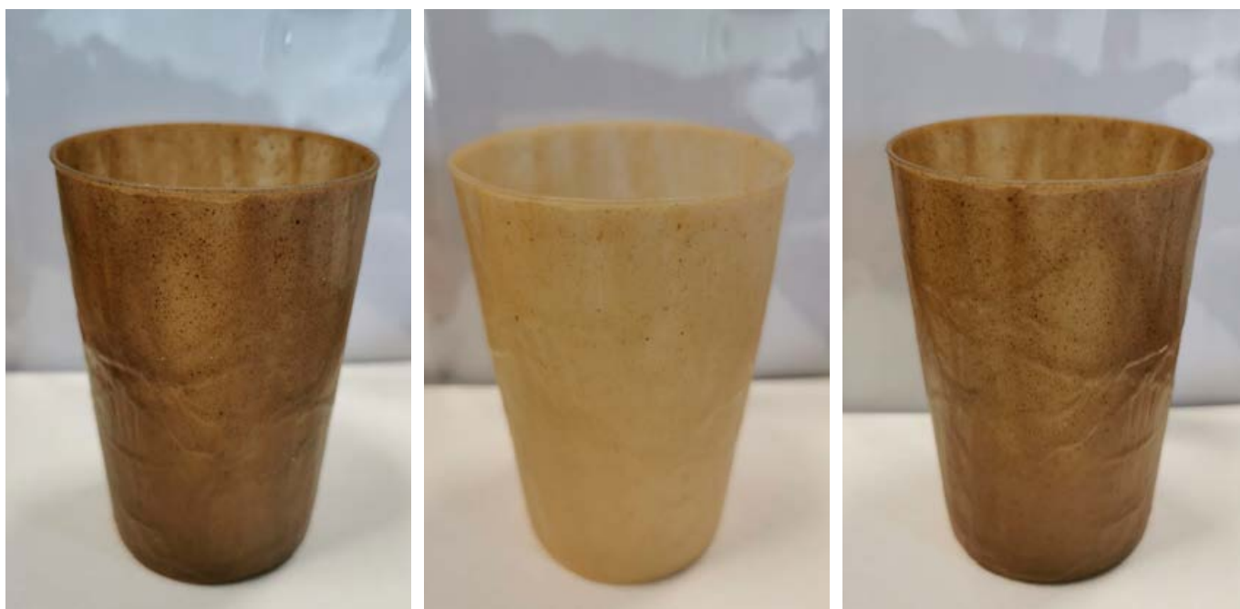
Lončki iz Green PE-HD in konoplje; tri različne izvedbe konopljinih vlaken
