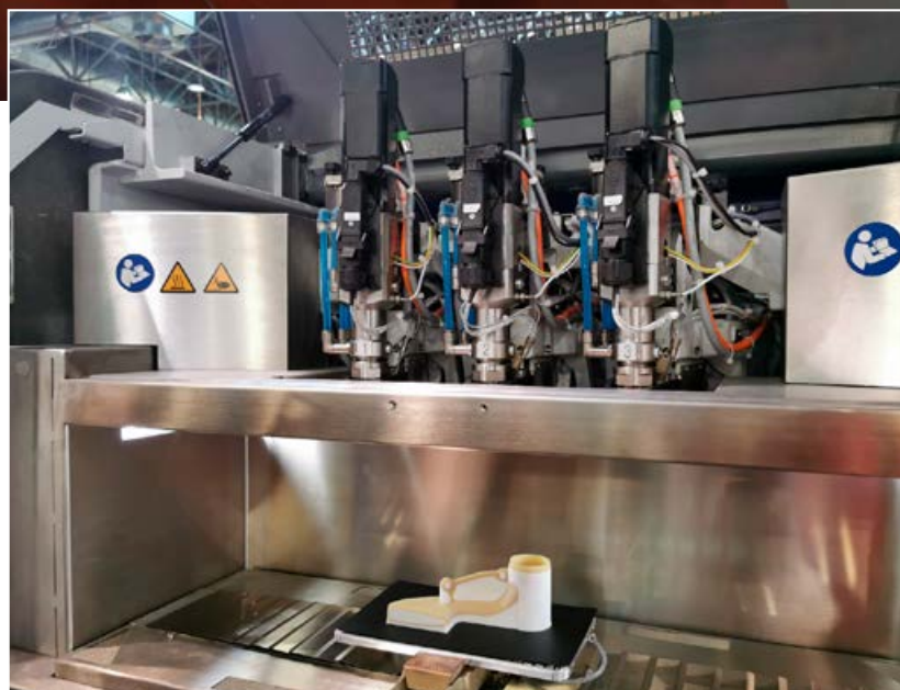
Notranjost 3D tiskalnika in natisnjen izdelek – 3D tiskalnik ima možnost tiskanja z dvema materialoma hkrati (eden kot glavni material in drugi za podpore, ki se potem odstranijo s topilom) – podjetje Arburg
