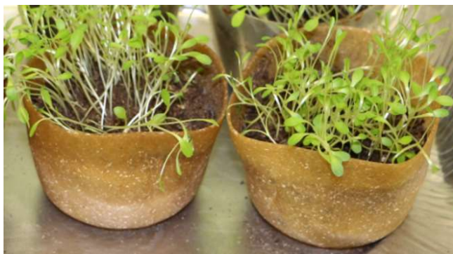
Slika 2: Testiranje različnih izvedb termoplastičnega škroba s simulacijo realnih pogojev uporabe
