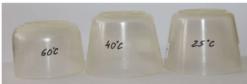
Slika 1: Vpliv temperature temperiranja na stopnjo kristaliničnosti (zgoraj), dinamični E modul (sredina) in dimenzije PLA brizganega kosa (spodaj)
