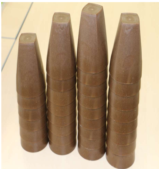
Slika 3: Lončki iz biokompozita na osnovi bioosnovanega PE-HD in konopljinih vlaken
