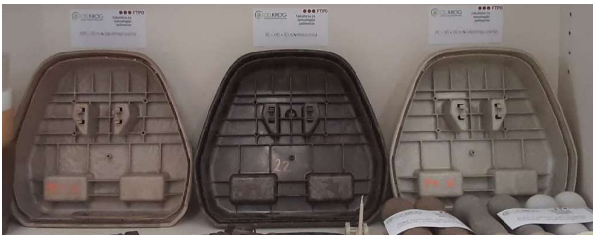
Slika 16: Izdelani prototipi (levo: ABS+ 30 % odpadnega papirja; sredina: Green PE-HD+30 % miskantusa + 15 % talka; desno: Green PE-HD+30 % odpadnega papirja + 15 % talka)
