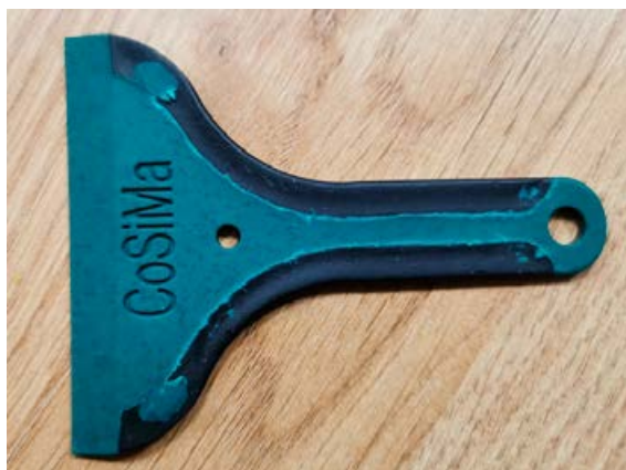
Izdelani vzorci iz recikliranega odpada poliestrskega flisa iz podjetja CAP, ki je bil dodan reciklatu termoplastičnega elastomera (zeleni del strgala levo in pripravljen granulat desno)
