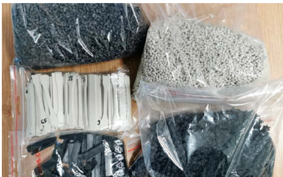
Izdelani vzorci termoplastičnih kompozitov iz odpada podjetja Technol in PA66 GF15, PA6 GF50, ABS GF30 in PP matricami
