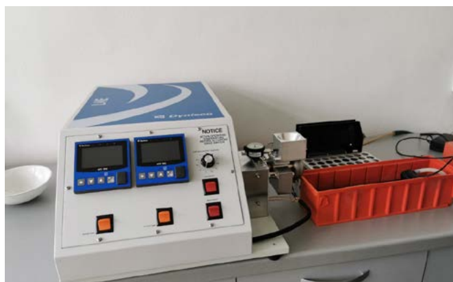
Mini ekstruder, brez polža, s katerim lahko pripravimo gramske količine polimerne mešanice ali kompozita
