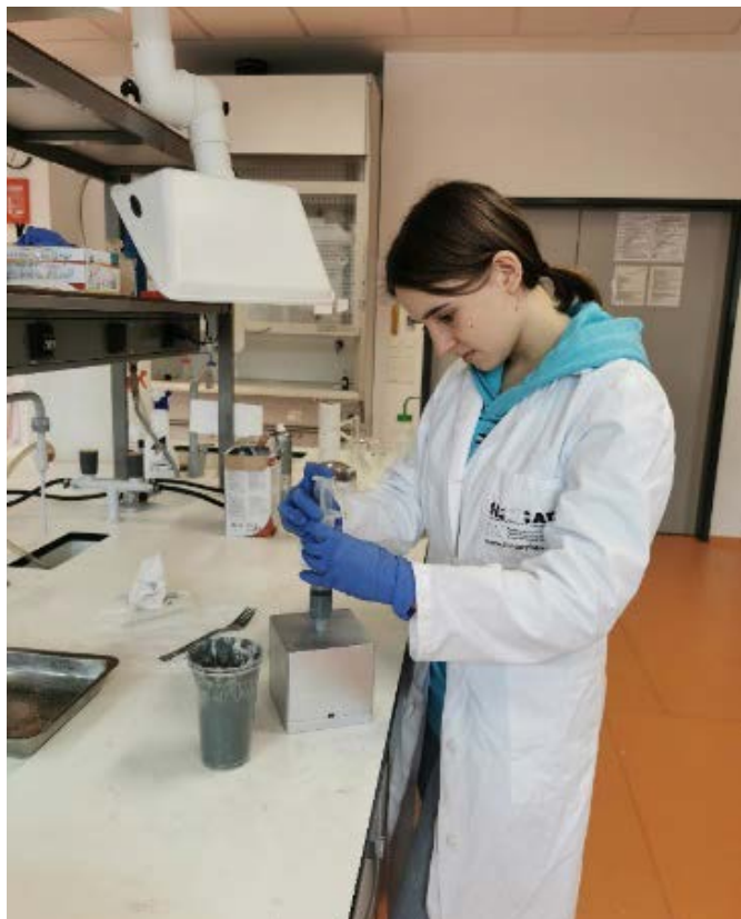
Brizganje zmesi silikona in ošilkov v kalup na Fakulteti za tehnologijo polimerov
