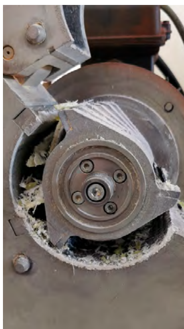
Retsch SM 2000 mlin, ki smo ga uporabili za mletje odpada duroplastičnega kompozita
