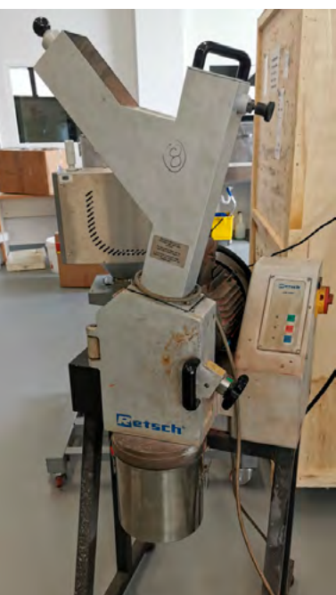
Retsch SM 2000 mlin, ki smo ga uporabili za mletje odpada duroplastičnega kompozita
