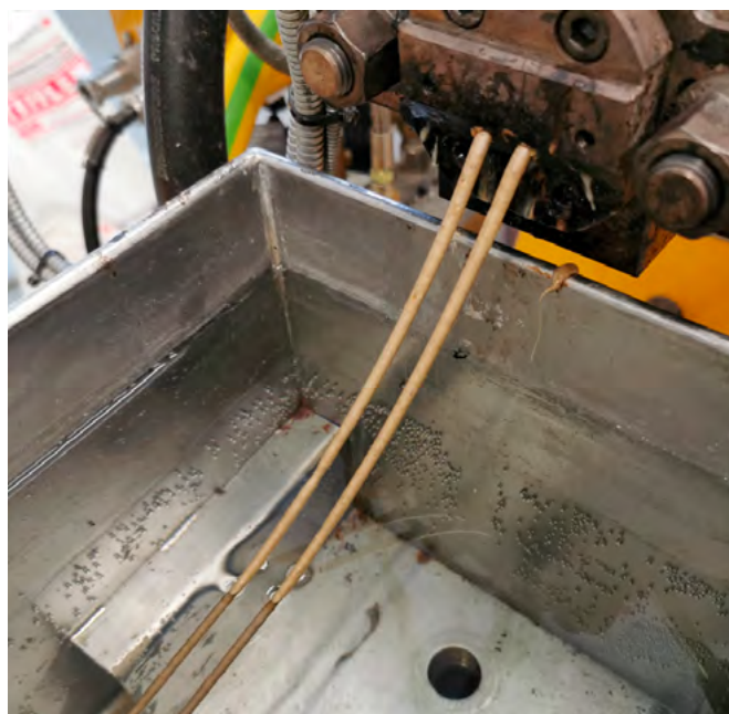
Slika ekstrudiranja biokompozita na osnovi PLA z dodatkom hmelja
