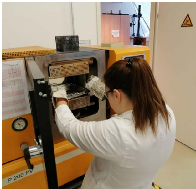
Priprava vzorcev za reometer na stiskalnici
