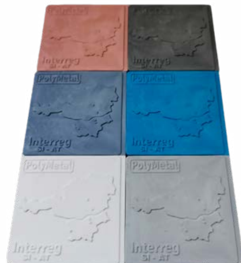
Demonstratorji PolyMetal projekta z visoko temperaturno prevodnim kompozitom in dodanimi barvili s kovinskim učinkom
