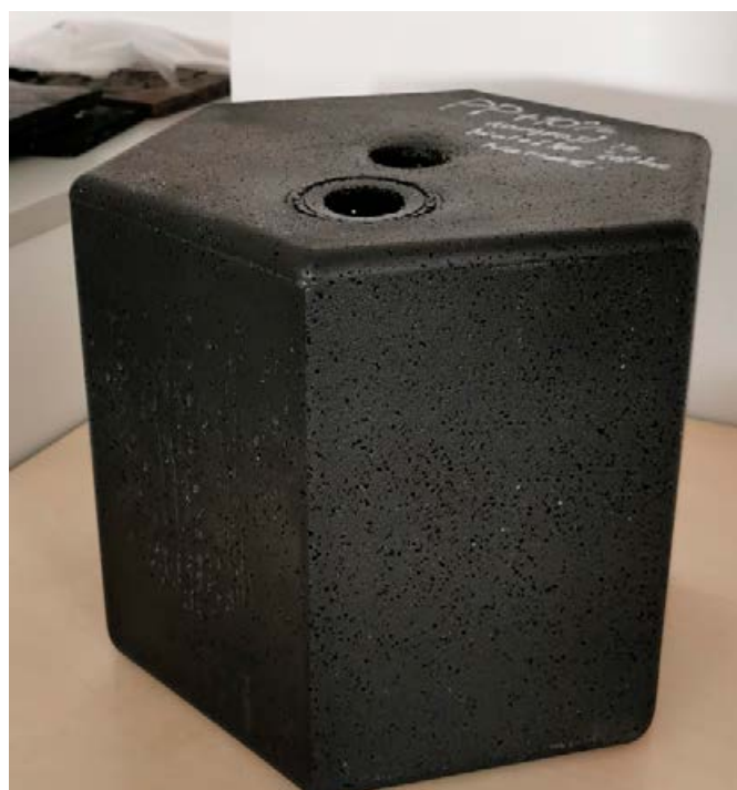
Demonstator iz recikliranega polipropilena z dodatkom odpadnega humusa iz bioloških čistilnih naprav
