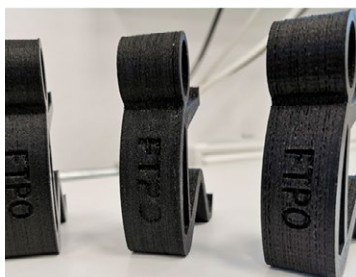
Tiskani kosi z rPA6 GF30; levi kos po optimizaciji, na sredini vmesna izvedba in desni prvi 3D natisnjen kos – najslabša kvaliteta površine
