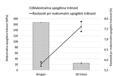
Primerjava nateznih in upogibnih trdnosti in raztezkov brizganih in 3D tiskanih kosov
