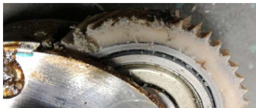
Test materiala Victrex PEEK 650G na končni aplikaciji – planetarni zobnik za električno kolo
