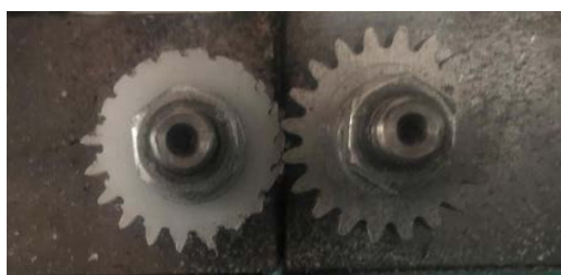
Zobniška kombinacija Tecaform AH – C45R po testu življenjske dobe z 1,1 Nm navora
