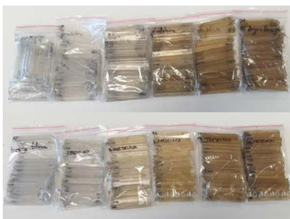
Nabrizgane testne epruvete iz linearnega (zgoraj) in razvejanega (spodaj) polikarbonata
