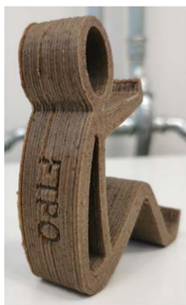
Prvi 3D natisnjen kos iz PLA matrice in dodanim hmeljem, ki ima najslabšo površino – kos je bil 3D natisnjen še brez optimizacije parametrov tiskanja
