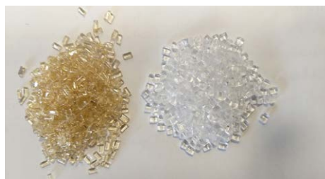
Primarni granulat (levo) in granulat po 11. predelavi (desno)
