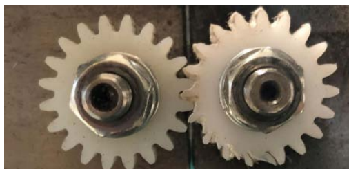
Zobniška kombinacija Tecaform AH – Tecamid 66 po testu življenjske dobe z 1,4 Nm navora
